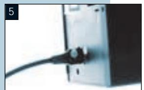
den Stecker des Netzkabels um 180 Grad drehen und noch einmal messen. Der niedrigere Wert zeigt die richtige Polung. Zum Schluss die Phase am Kabel (wenn notwendig, an beiden Enden und am Gerät) markieren. Für Schutzgeerdete Geräte (viele High-End-Modelle) gilt die gleiche Prozedur. Allerdings funktioniert die Messung dann nur mit Netzkabeln, deren Schutzkontakt abgeklebt ist. Vorsicht: Zwischen Gerätemasse und Schutz-erde können bis zu 115 Volt liegen.
